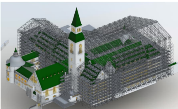
Kuva 1-4. Lohkojen 2 ja 3 telinesuunnitelmien 3D-mallinnos, sekä aluesuunnitelma, jossa näkyy sääsuojien lohkojen sijainti.
